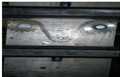
الشكل (8) نقل الحركة بواسطة جنازير وتروس
