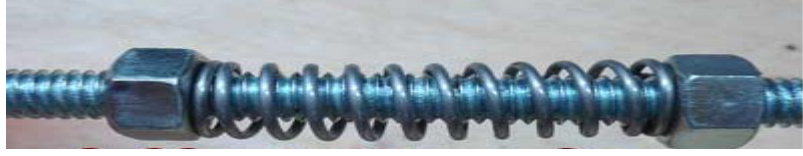
الشكل (9) نقل الحركة بواسطة عمود مسنن
