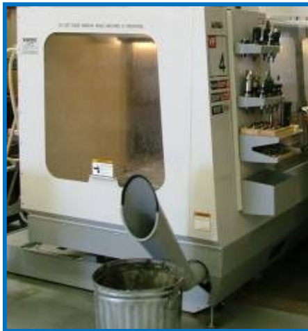
الشكل (٢١): تفريغ الرئش بشكل آلي
