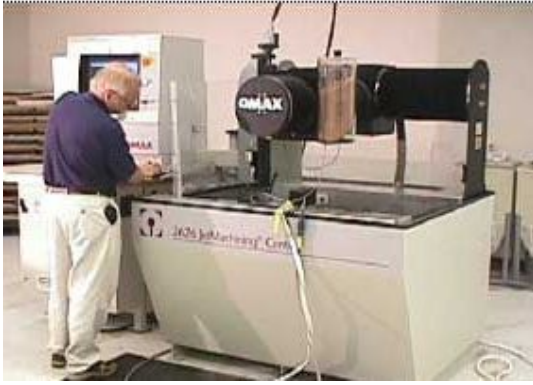
الشكل (٧): آلة قص بالماء CNC
