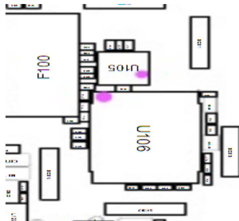
٦/ IC المسئول عن التوصيل بواسطة البلوتوث والشبكة اللاسلكية (الواي فاي).
